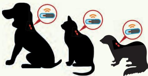
Sistema del tamaño de un grano de arroz que contiene un número único utilizado para identificar a un animal. Fiable, seguro y de fácil aplicación.
